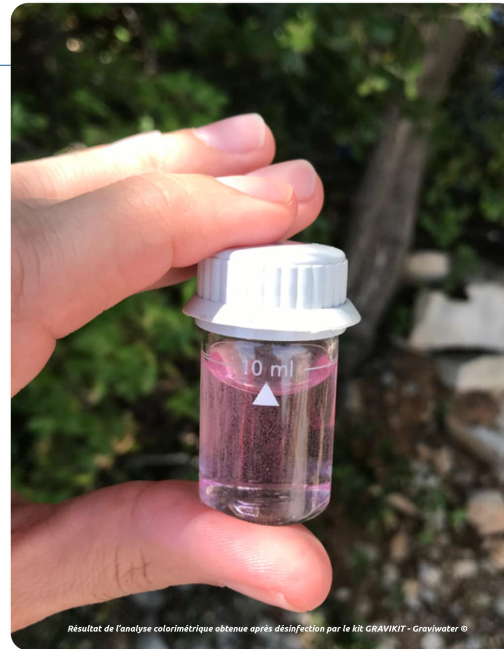
Résultat de l'analyse colorimétrique obtenue après désinfection par le kit GRAVIKIT - Graviwater ©
